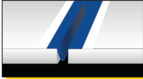
Расположение Mapeband в форме буквы Ω в деформационном шве
