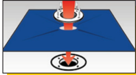
Установка прокладки для эластичной гидроизоляции и герметизации дренажных отверстий (400x400 мм)
