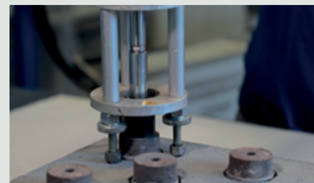
Измерение силы сцепления при отрыве в соответствии с EN 1542.
