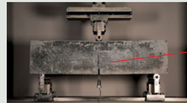
Измерение остаточной прочности на изгиб в соответствии с EN14651.
